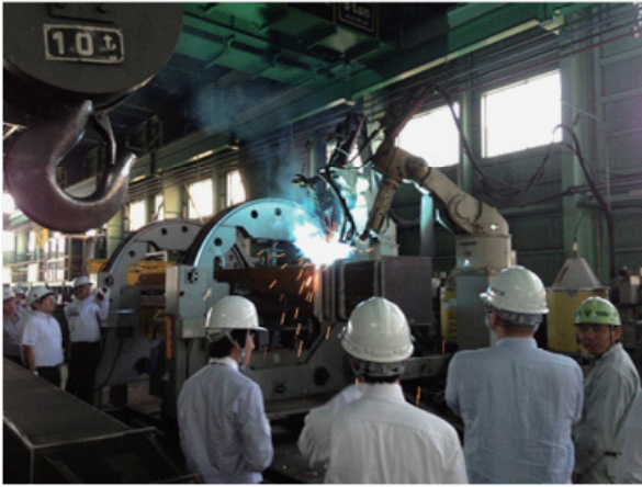
写真3 株式会社竹原鉄工所にて、24時間無人稼働のロボット溶接装置
