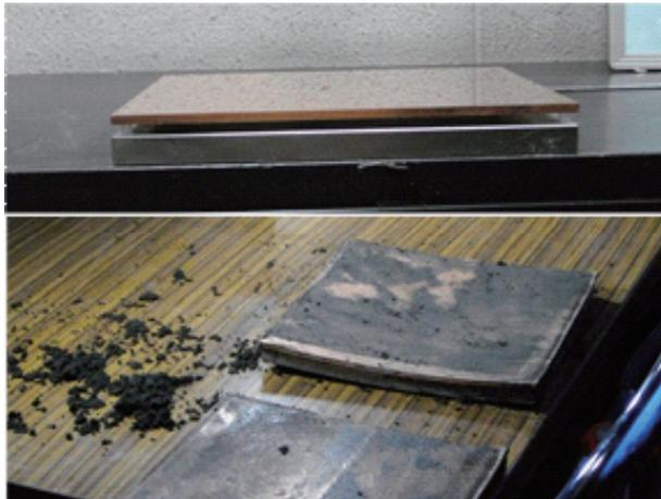
図3 爆着前後の被接合材
